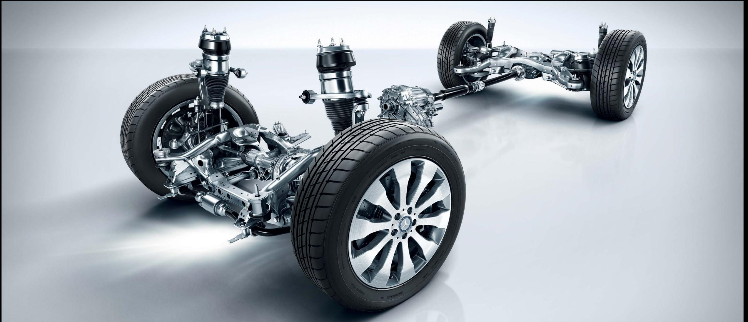
AIRMATIC 에어 서스펜션은 ADS PLUS 어댑티브 댐핑 시스템을 사용해 편안한 승차감과 뛰어난 주행 역동성 두 가지 모두를 만족시켜 줍니다. 주행 상황과 노면 조건에 따라 각 바퀴의 댐핑 감쇠력을 스스로 조절합니다. 코너링이나 제동 시 발생하는 차체의 롤링과 피칭도 효과적으로 감소시켜 줍니다. AIRMATIC 에어 서스펜션은 댐핑 특성을 편안하게 또는 스포티하게 변경 설정할 수 있습니다. 지상고 자동 조절 시스템으로 차량의 적재량과 주행 조건에 상관없이 일정하게 지상고를 유지할 수 있습니다. 고속 주행이나 “Sport” 변속 모드에서는 차체를 15mm 낮춰 공기 저항을 줄이고 주행 안정성을 높여줍니다. 지상고를 최대 90mm까지 더 높여 오프로드 성능을 극대화할 수도 있습니다.
