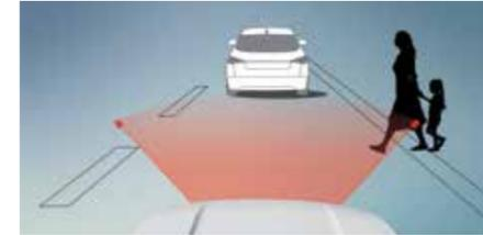
**긴급 제동 보조 AEB (Autonomous Emergency Braking)**
