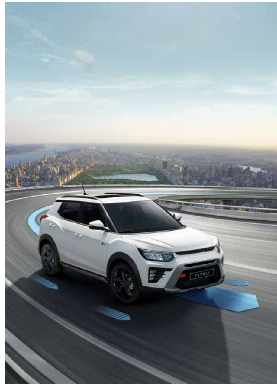
차량전복 방지장치 ARP (Anti-Rollover Protection) 고속주행 중 급선회 구간에서 각 바퀴의 브레이크와 엔진출력을 조절하여 차량의 전복을 방지시켜 줍니다.
